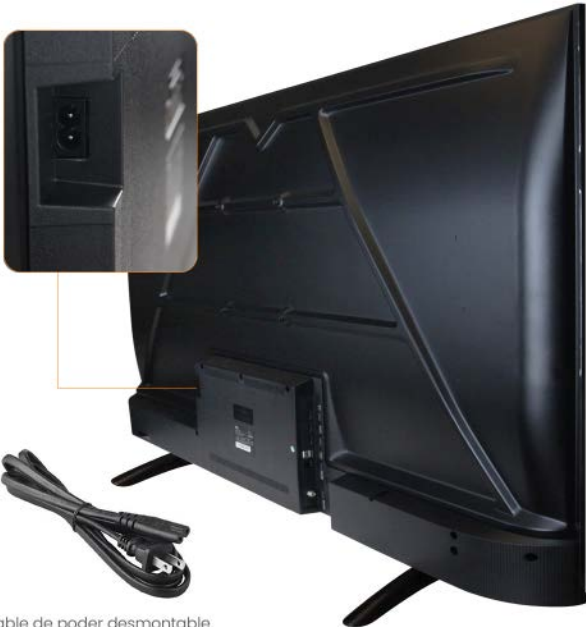
Cable de poder desmontable
